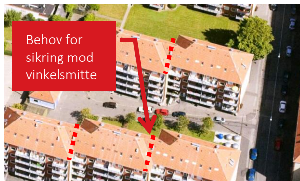
Når en brandsektionsadskillelse er placeret således, at der mellem bygningskonstruktionerne på hver side af adskillelsen, er en vinkel på mindre end 135^\circ grader, er der behov for sikring mod vinkelsmitte. Foto: fra www.krak.dk
